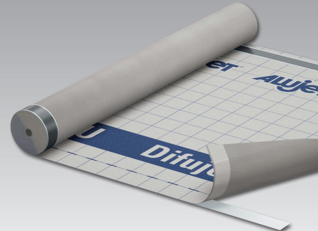
Die ALUJET Difujet BLU ist eine 3-lagige, reißfeste, diffusionsoffene Unterdeck- und Unterspannbahn aus einem Microfaser-Vlies- und Folienverbund.
